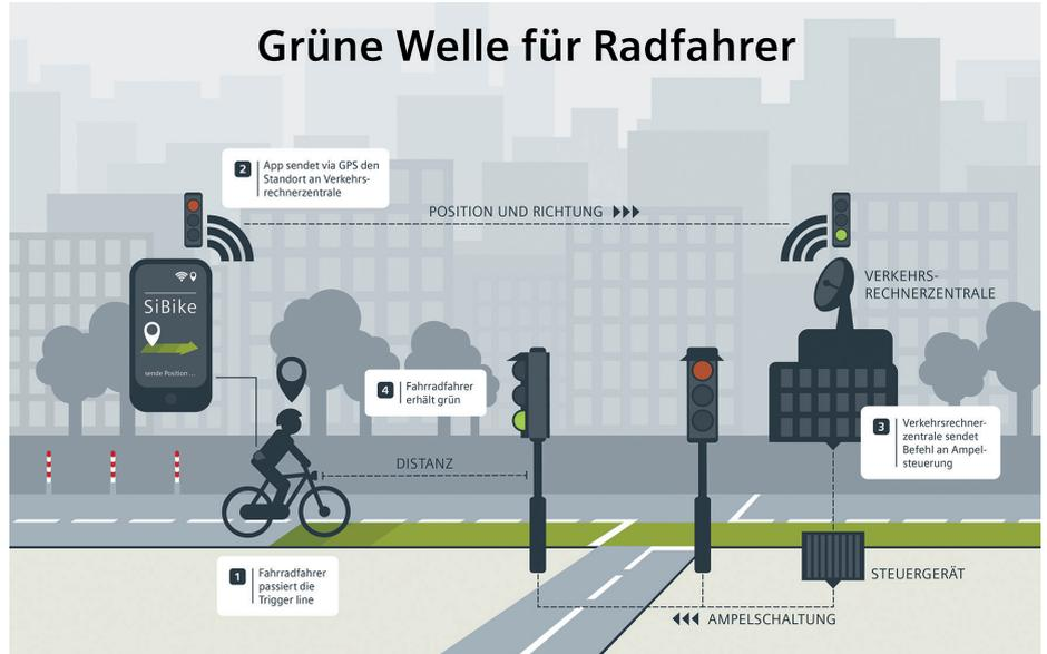
Bild 1: Sitraffic SiBike – die „Grüne Welle“ für Radfahrer (Siemens AG 2017)
